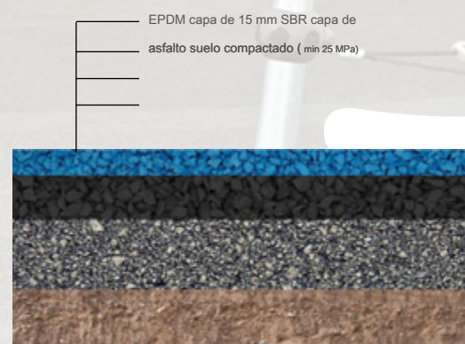
Detalle de la sub-base para flexotop - Asphalt
